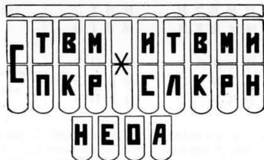
Рис. 5. Расположение клавишей букв на машине.
